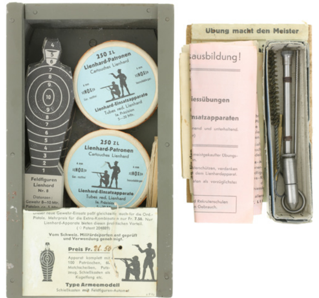
59903 CHF 120.- 274868 Universal-Matchapparat «Lienhard», Mod. G, Einsteckklau für Gewehr und Karabiner, Kal. 4 mm. TL 123 mm, gezogener Stahl Lauf mit aufgeschraubtem Übergangskonus. Stählerne Ladepatrone zur Aufnahme des Zündhütchens. Kugelfangboxen mit Drehscheibenmechanismus als Aufbewahrungsbox, Reinigungsbürste, Werghalter, Schraubenzieher, Kugelfang, Match - und Figurenscheiben und «Lienhard-Munition». #ohne Zustand 1
