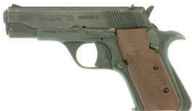
54286 CHF 110.- 272631 Pistole, Trejo Mod. 1-A, Kal. .22LR. LL 83mm, TL 170mm, brünierte Ganzstahlwaffe mit Feder/Masse-Verschluss. In Europa recht seltene mexikanische Pistole, SA-Abzug, aussenliegender Hahn, eingeschobene Kimme, Blockkorn. Griffschalen aus braunem Kunststoff mit Trejo-Logo und Fischhautmuster. #5630 WES Zustand 2
