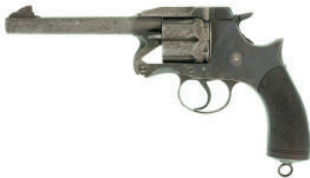
54743 CHF 1200.- 224704 Revolver, Enfield 1880 Mark I, Kal. .476. LL 150mm, TL 298 mm, brünierte sechsschüssige Kipplaufwaffe, Entriegelungstaste auf der rechten Rahmenseite. Der Vorlauf der Trommel ist auf die Länge der leeren Hülse abgestimmt, so dass ganze Patronen nicht ausgeworfen werden, abgeschossene Hülsen jedoch schon. Das Nachladen erfolgt über eine linksseitige Ladeklappe. Double-Action Schloss, geflutete Trommel, einteiliger Holzgriff mit Fischhautverschnitt. Griffkappe mit festem Fangschnurring. Englische Armee-Abnahme "WD" (War Departement) sowie auf dem Griff Rücken "N" (Naval Service). Anm: Es wurden nur sehr wenige Mark I hergestellt, schon im August 1881 wurden diverse Abänderungen beschlossen und als 1882 Mark II eingeführt. Die meisten Mark I wurden mit den Sicherheitselementen des Mark II nachgerüstet; dieser befindet sich noch im originalen Zustand. #11006 WES Zustand 2
