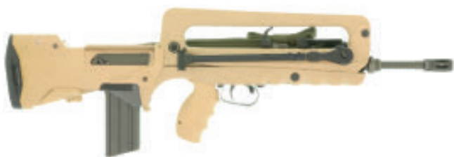
54741 CHF 1500.- 274106 Sturmgewehr, FAMAS F1, Kal. .223Rem. LL 520mm, TL 765 mm, Rückstossloader mit verzögertem Rücklauf. Bullpup-Waffe, mehrheitlich aus "desertpinkem"(sic) Kunststoff gefertigt. Verstellbare Dioptervisierung im Handgriff integriert. Lauf mit Aufnahme für Gewehrgranaten, progressiver Abzug, Feuerwahlhebel auf Kolbenunterseite, Zweibeinstützen, Sicherungshebel vor dem Abzug. Magazinschachtbeschriftung "FA-MAS 5.56-F1". #SP888 SON Zustand 1
