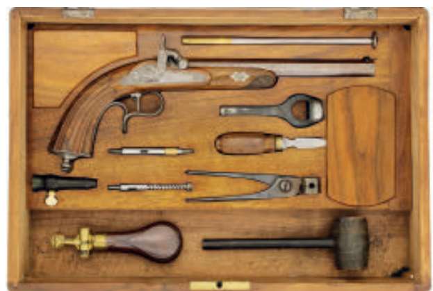
54060 CHF 1600.- 272273 Perkussionsscheibenpistole, belgisch, Kal. 10mm. LL 225mm, TL 393mm, gezogener Achtkantdamastlauf, 8 Züge. Kimme in der Rückstossplatte eingesetzt, Perlkorn seitlich eingeschlaucht. Flache, hinten abgestufte Schlossplatte, Rückstecker. Laufschnanzschraube, Hahn, Schlossplatte, Abzugsbügel und Kolbenabschluss grau gebeizt mit Rand- und Eichenlaubgravur. Beschnittene Nussholzhalbschäftung, Griff mit Längsrillen. Zubehör: Kasten aus Nussholz, reichhaltiges Zubehör wie Kugelzange, Ladestock, Pulverdose, Pulverdosierer, Schraubenzieher, Locheisen, Ladehammer und Putzzeug. #618 ANT Zustand 1
