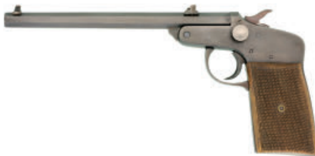
54169 CHF 90.- 273164 Kipplaufpistole, B&A, Kal. .22LR. LL 185mm, TL 255mm, brünierte Ganzstahlwaffe, SA-Abzug, aussenliegender Hammer, seitlicher Öffnungsknopf. Standvisier, seitlich eingeschlaufftes Perlkorn. Deutscher Beschuss: Adler über "N". Nussholzgriffschalen mit Fischhautverschnitt. #3915 WES Zustand 1
