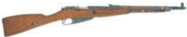
47974 CHF 280.- 254553 Repetierbüchse, Moisin-Nagant Mod. 1944, Ländercode 02 (Ungarn), hergestellt 1953, Kal. 7.62x54R. LL 510 mm, TL 1020 mm, Zylinderverschluss mit zwei Verriegelungswarzen, Kastenmagazin, Leitkurvenvisier einstellbar bis 1000 m, Blockkorn mit Korntunnel. Vorne am Lauf ist ein schwenkbares Stichbajonett befestigt. Buchenholzschäftung, eiserne Kolbenkappe. Deutscher Neubeschuss. #BH7086 WES Zustand 2
