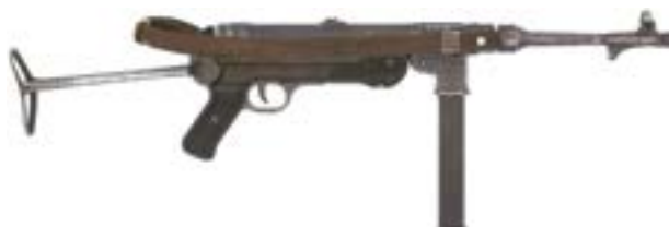
42899 CHF 1500.- 241010 Maschinenpistole, MP 40, bnz41 (Steyr-Daimler-Puch), Kal. 9mmP. Verschluss zuschiessend, Gehäuse aus gepresstem Stahl gefertigt, Standvisier mit zusätzlichem klappbarem Kimmenblatt, Balkenkorn mit Korntunnel. Abzuggehäuse und Griffschalen aus Bakelit. Skelettschaft nach unten umklappbar. #1949k Zustand 1
