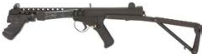
42898 CHF 500.- 240717 Maschinenpistole, Sterling Police Carbine MK 4, Kal. 9mmP. LL 200mm, TL 690mm, zuschiessendes System, schwarzer Schrumpflacküberzug auf der ganzen Waffe. Umklappbarer Diopter, Blockkorn mit Seitenbacken. Linksseitig am Griffstück kann über einen Flügel die Feuerwaff eingestellt, bzw. gesichert werden. Schwarze Kunststoffgriffschalen. Nach unten umklappbarer Skelettschaft, Vordergriff am Mantelrohr bzw. am Bajonethalter befestigt. Tasche mit 3 Reservemagazinen. #P0479 Zustand 2
