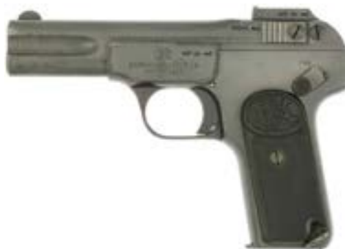
42191 CHF 120.- 241215 Pistole, FN 1900, Kal. 7.65mm. LL 100mm, streichbrünierte Ganzstahlwaffe mit SA-Abzug. Starre Visierung, Gepresste Hartgummigriffschalen mit Firmenlogo und Fischhautmuster. Belgischer Beschuss. Fangschnurbügel an der linken Griffseite. Erste in Grossserie von FN hergestellte Selbstlade-pistole konstruiert von John Moses Browning. #583548 Zustand 1
