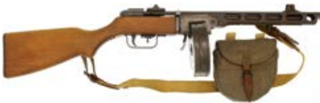
42896 CHF 200.- 240719 Maschinenpistole, PPSH 41, hergestellt 1951, Ländercode 01 im Kreis, Kal. 7.62x25mm. Feder/Masseverschluss, System zuschiessend, Gehäuse aus gepresstem Stahlblech, brüniert. Klappbare Kimme mit zwei Stellungen, Blockkorn mit Kornschutz. Schaft aus Buchenholz, eiserne Kolbenkappe mit Fach für Reinigungsutensilien. Grüne textile Tasche für Trommelmagazin. #AF2556 Zustand 2
