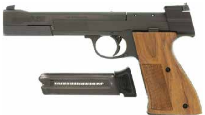
23960 CHF 330.- 271273 Sportpistole, Hämmerli 215, Kal. .22LR. LL 150mm, TL 250mm, brünierte Ganzstahlwaffe mit SA-Abzug, Triggerstop, Mikrometervisier, auswechselbares Blockkorn. Lackierte Nussholzgriffschalen ohne Handauflage, sog. Jägerschaftsausführung. #G67536 WES Zustand 1
