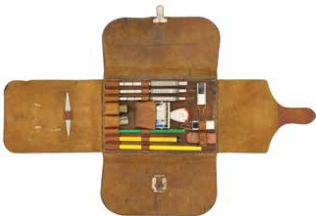
23894 CHF 280.- 274851 Waffenkontrollleur-Etui für K31/Stgw57, LMG, SIG SP47/8. Auffaltbares, ledernes Etui, enthaltend: 1. Laufkaliber „9mm SP.47/8 SJG“, 8.81mm - 8.91mm. 2. Laufkaliber „WCD 230“ zu LMG 25, 7.45mm - 7.70mm. 3. Laufkaliber „WCD 316“ zu K31/Stgw57, 7.55mm - 7.67mm. 4. Lauflupe, Schliessabstandlehre Stgw57, 2 Laufspiegel. 5. Waffenkontrollleur-Stempel, Schreibzeug mit Radiergummi und Spitzer. Zustand 1
