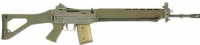
23974 CHF 1200.- 274878 Selbstladebüchse, SIG, PE 90, Kal. .223. LL 530mm inkl. Mündungsbremse, TL 1000mm, Werkshalbautomat des Sturmgewehres 90. Gasdrucklader mit Drehwarzenverriegelung. Metallteile mit grüner Ilaflonbeschichtung, Vorderschaft, Pistolengriff und Klappschaft aus grünem Kunststoff, Webtragriemen. #PE5757 ABK Zustand 1
