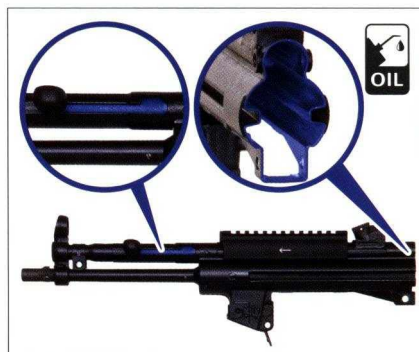
Abb. 66: Schmierstellen der Funktionsteile
