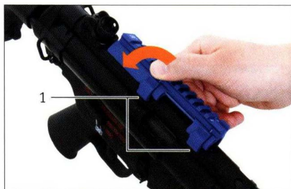
Abb. 68: Adapter mit Picatinny-Schiene montieren
