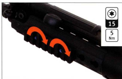
Abb. 74: Schrauben für Picatinny-Schiene festziehen
