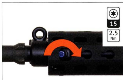
Abb. 71: Halteschraube für Handschutz festziehen
