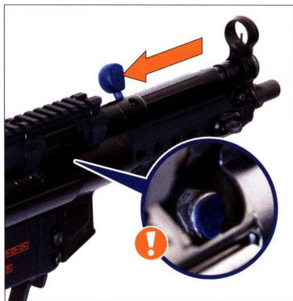
Abb. 25: In das Patronenlager schauen
