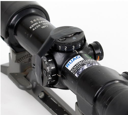
Abbildung 13 Fixierung Höhen-und Seitentrommel
